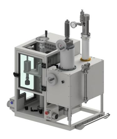
Die halbautomatische BOV-Abfüllmaschine mit Mischer BOV Z-2343 ist ein Gerät zum Abfüllen von Aerosolbehältern mit einem flüssigen Produkt über Bag-On-Valve-Ventile, die auf den Aerosolbehälter gecrimpt werden. Die Menge des dosierten Produkts ist im Bereich von 0 bis 294 ml einstellbar. Ein integraler Bestandteil des Geräts ist ein Mischer zum Mischen des Gelprodukts mit verflüssigtem Isopentan-Gas. Die Anteile der Mischung sind einstellbar. Die Maschine ist mit 2 Arbeitsköpfen ausgestattet:
