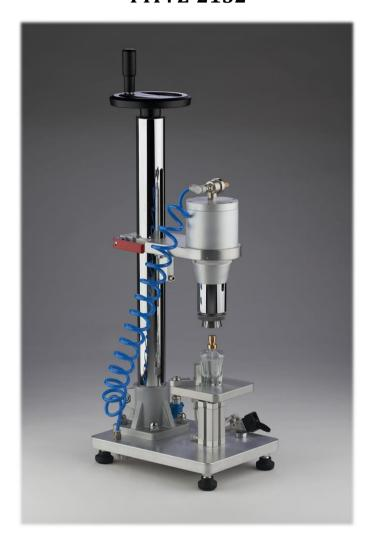
Das Gerät dient dazu, Zerstäuber präzise auf Glasflaschen zu crimpen. Das Gerät ist für einen reibungslosen Betrieb und eine präzise Crimpeinstellung konzipiert und gebaut. Die verschiedenen Arten und Formen der Crimpbacken, die genau auf den Durchmesser der Zerstäuber abgestimmt sind, verhindern eine Beschädigung der Zerstäuber und Flaschen.
