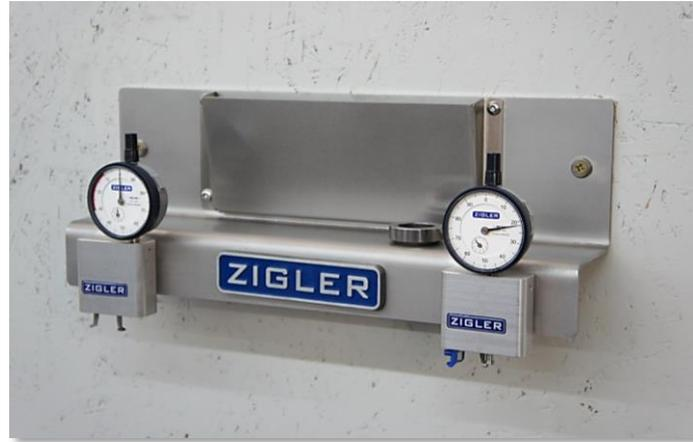
Das PPMS ist ein zusätzliches Instrument, das eine Prüfstandsfunction für alle Parameter im Zusammenhang mit der Aerosolproduktion bietet. In der Standardausführung bietet es die Möglichkeit der Befestigung von 2 Messgeräten und arbeitet mit den folgenden Gerätetypen:
