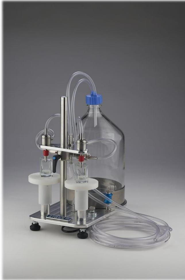
La macchina è adatta al riempimento di bottiglie di vetro indipendentemente dalla capacità. Il riempimento viene effettuato "a livello", ovvero il processo continua finché l'altezza del prodotto riempito non raggiunge il livello richiesto.
