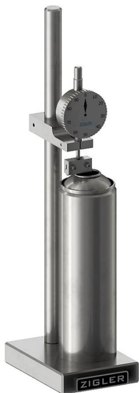
Il PPCP è fondamentale per garantire che le bombolette aerosol funzionino correttamente e in sicurezza. Il suo utilizzo consente di monitorare il parallelismo tra il piano di apertura e la base della bomboletta, un aspetto cruciale per il corretto funzionamento della valvola.
