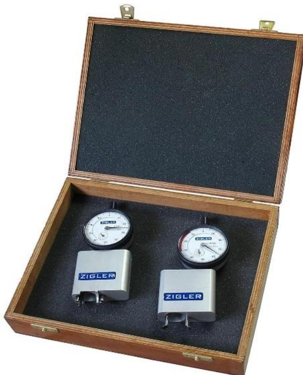
Set di strumenti per il controllo della forza di aggraffatura. Ogni set comprende due strumenti di misura e un anello di calibrazione.
