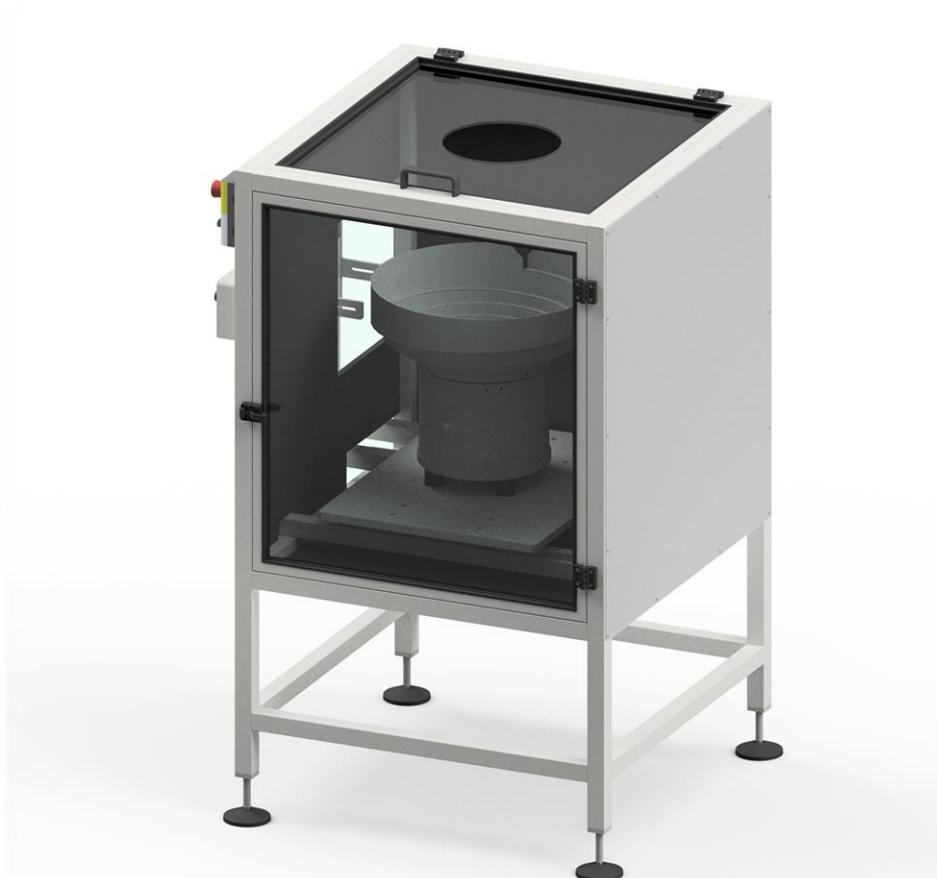
Il selezionatore vibrante è predisposto per il convogliamento di elementi adeguatamente orientati (erogatori, tappi, valvole) all'inseritore / alla macchina tappatrice.
