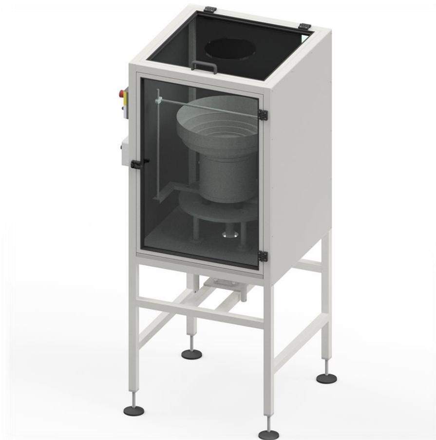
Il selezionatore vibrante è predisposto per il convogliamento di elementi adeguatamente orientati (erogatori, tappi, valvole) all'inseritore / alla macchina tappatrice. Nella parte superiore del selezionatore c'è una tramoggia nella quale gli elementi vengono orientati e convogliati sulla guida sotto l'effetto delle vibrazioni controllate e grazie alla pista a spirale adeguatamente conformata. La macchina è dotata di cassette di comando speciali progettati per il selezionatore vibrante.
