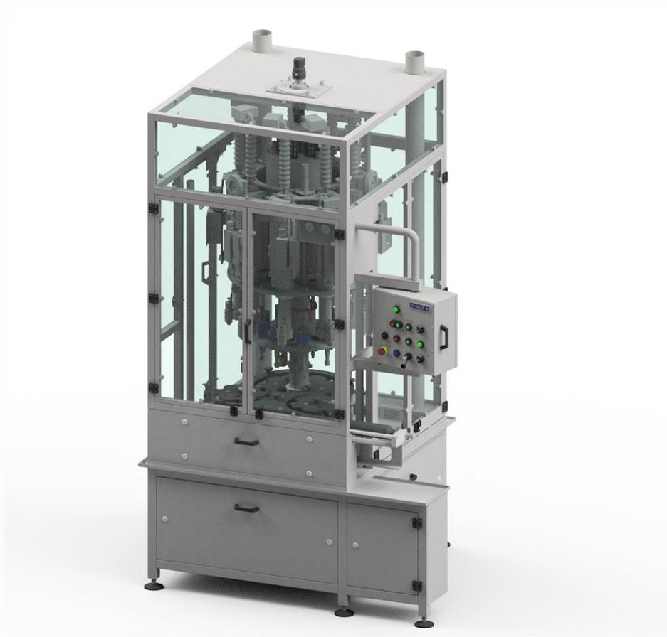
Il modulo di gassatura rotante ZIGMAT tipo Z-1412 fa parte della linea di produzione di bombolette spray e serve per riempire contenitori per aerosol di propellente attraverso la valvola aerosol aggraffata. Questa operazione viene eseguita da 9 moduli di gassatura. La produttività nominale della macchina raggiunge 180 pezzi al minuto. Tutti i cicli di lavoro vengono eseguiti durante il movimento rotatorio (continuo) dovuto a un motopropulsore elettrico.
