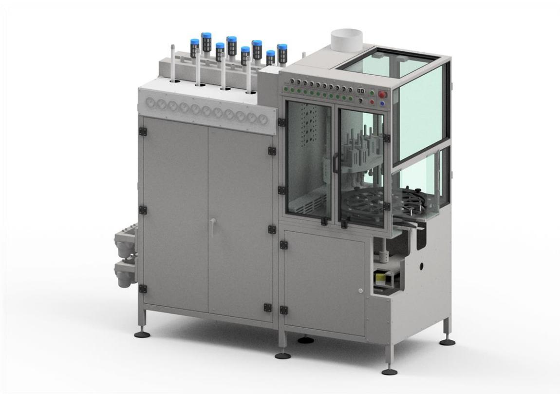
Il modulo di gassatura automatico Z-1070 fa parte della linea di produzione automatica di bombolette spray e serve per realizzare le seguenti operazioni:
