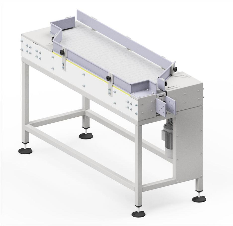
Der Verteilungstisch Z-5202 ist ein Bestandteil der Aerosolproduktionsanlage. Die Grundfunktion des Verteilungstisches besteht darin, die Warteschlange der Aerosoldosen, die vom Aufgabetisch gebildet werden, in 2 separate Warteschlangen zu verteilen, um die Dosen an 2 eigenständige Verarbeitungsmaschinen zu liefern.
