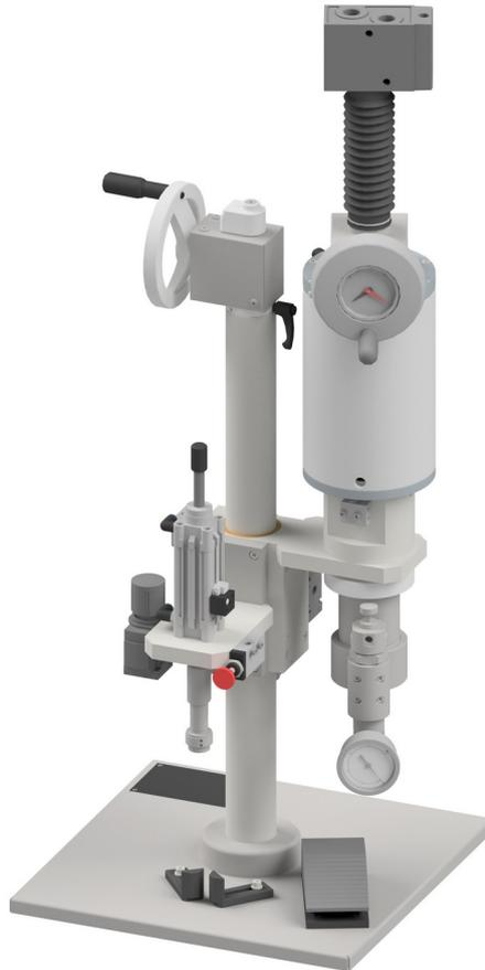
Die halbautomatische Gasfüllvorrichtung Z-2003 ist eine Vorrichtung zum Befüllen von Aerosolbehältern mit Treibgas durch gecrimpte Aerosolventile. Die Treibmitteldosis ist im Bereich von 5 bis 510 ml (je nach eingebautem Zylinder) einstellbar und mit einer Genauigkeit von 0,5 ml<sup>1</sup> wiederholbar. Die Maschine kann als ein halbautomatisches Tischmodell mit manueller Steuerung oder als eine wartungsfreie Baugruppe in einem automatischen Rundlaufmodul montiert werden
