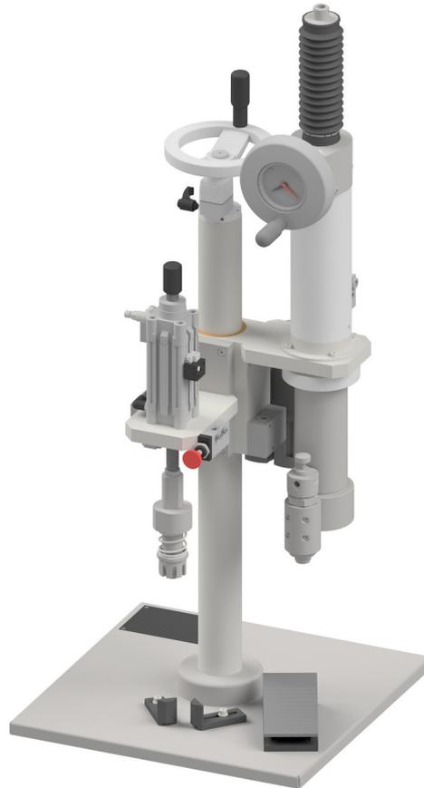
Die halbautomatische Füllvorrichtung Z-2001 ist eine Vorrichtung zum Befüllen von Aerosolbehältern mit einem flüssigen Produkt (Wirkstoff). Die einzuspritzende Dosis des Produkts ist im Bereich von 5 bis 510 ml einstellbar (abhängig vom installierten Zylinder) und mit einer Genauigkeit von 0,5 ml1 wiederholbar. Die Maschine kann als ein halbautomatisches Tischmodell mit manueller Steuerung oder als eine wartungsfreie Baugruppe in einem automatischen Rundlaufmodul installiert werden.
