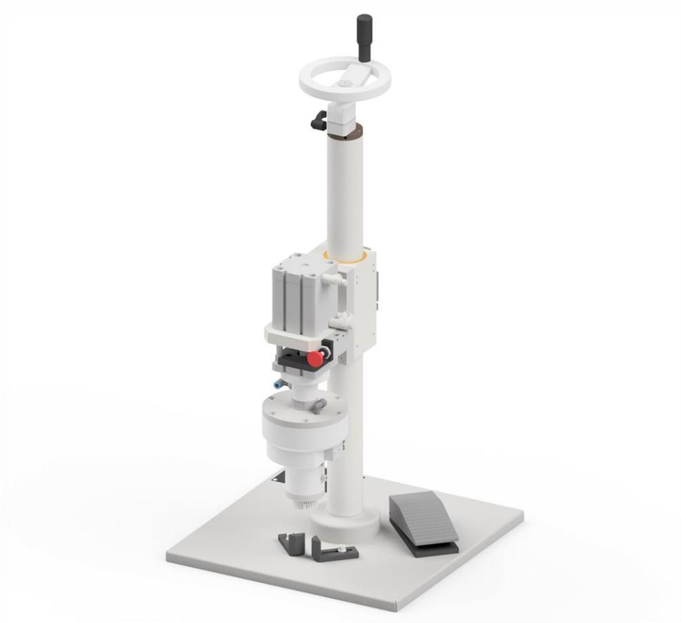
Il macchinario è progettato per aggraffare in maniera precisa nebulizzatori su flaconi di vetro. Il macchinario è stato progettato e costruito in modo tale da garantire un funzionamento regolare e una regolazione precisa di aggraffatura. Diversi tipi e forme delle ganasce di aggraffatura, adattate in maniera precisa al diametro del nebulizzatore, prevengono la degradazione di nebulizzatori e flaconi.
