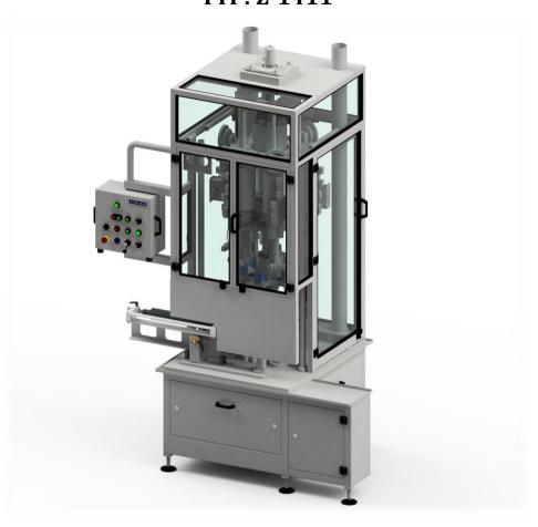
Das Rundlaufgasfüllmodul ZIGMAT 120-1 Z-1411 ist ein Bestandteil der Produktionsstraße und dient zum Befüllen von Aerosolbehältern mit Treibmittel durch ein gecrimptes Aerosolventil. Die Aufgabe wird mit 6 Gasfüllmodulen ausgeführt. Die Nennkapazität der Vorrichtung beträgt bis zu 120 Stück/Minute. Alle Arbeitszyklen finden während eines kontinuierlichen (ununterbrochenen) Rundlaufs statt, der durch das elektrische Antriebssystem erzwungen wird.
