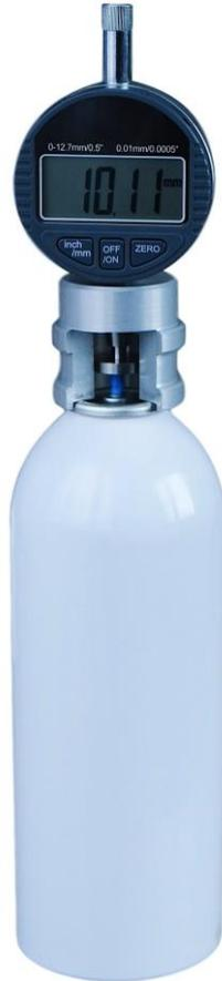
PPSH - ein Instrument zur Messung der Höhe von Aerosolventilschäften.
