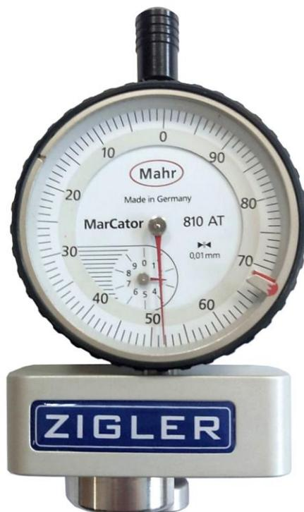
PPHK - strumento per il controllo del contatto tra i contenitori per aerosol e la chiusura scanalata del diametro di 1 pollice (25,4 mm). Ogni set comprende un sensore e un anello di calibrazione.
