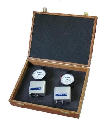
Ein Satz von Instrumenten zur Crimpmessung. Jeder Satz besteht aus zwei Messgeräten und einem Kalibrierring:
