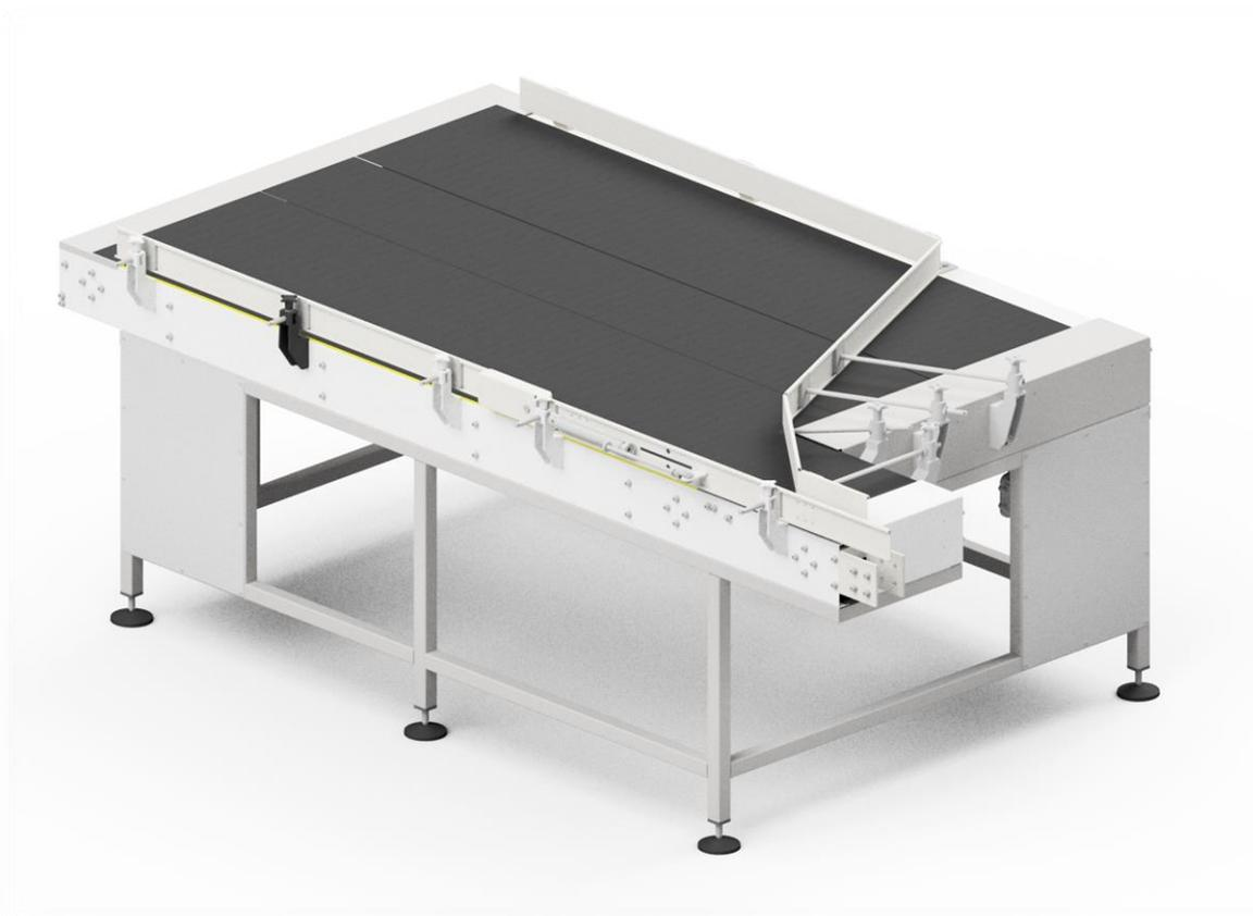
Il tavolo di carico Z-5204 è situato all'inizio della linea di produzione delle bombolette spray. Il principale compito del tavolo di carico è quello di fornire agli altri macchinari, in modo continuo, recipienti vuoti, in base ai fabbisogni della linea di produzione. Il tavolo è dotato di un sistema che impedisce il blocco di recipienti all'uscita dal tavolo.
