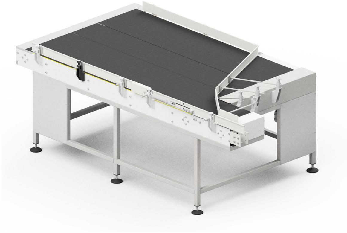
Der Aufgabetisch Typ Z-5204 ist ein Eingangsgerät der Prozessstraße zur Herstellung von Aerosolprodukten. Die grundlegende Aufgabe des Aufgabetisches besteht darin, leere Behälter an die nachgeschalteten Maschinen entsprechend den Bedürfnissen der Prozessstraße kontinuierlich einzuspeisen. Der Tisch wurde mit einem System ausgestattet, das die Stauung von Behältern im Ausgangssegment des Tisches verhindert.
