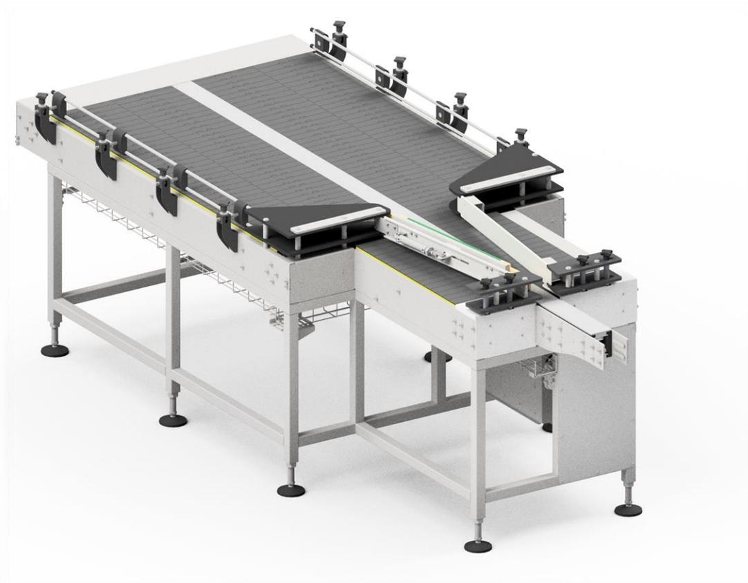
Il tavolo di carico Z-5201 è situato all'inizio della linea di produzione delle bombolette spray. Il principale compito del tavolo di carico è quello di fornire agli altri macchinari, in modo continuo, recipienti vuoti, in base ai fabbisogni della linea di produzione. Il tavolo è dotato di un sistema che impedisce il blocco di recipienti all'uscita dal tavolo.
