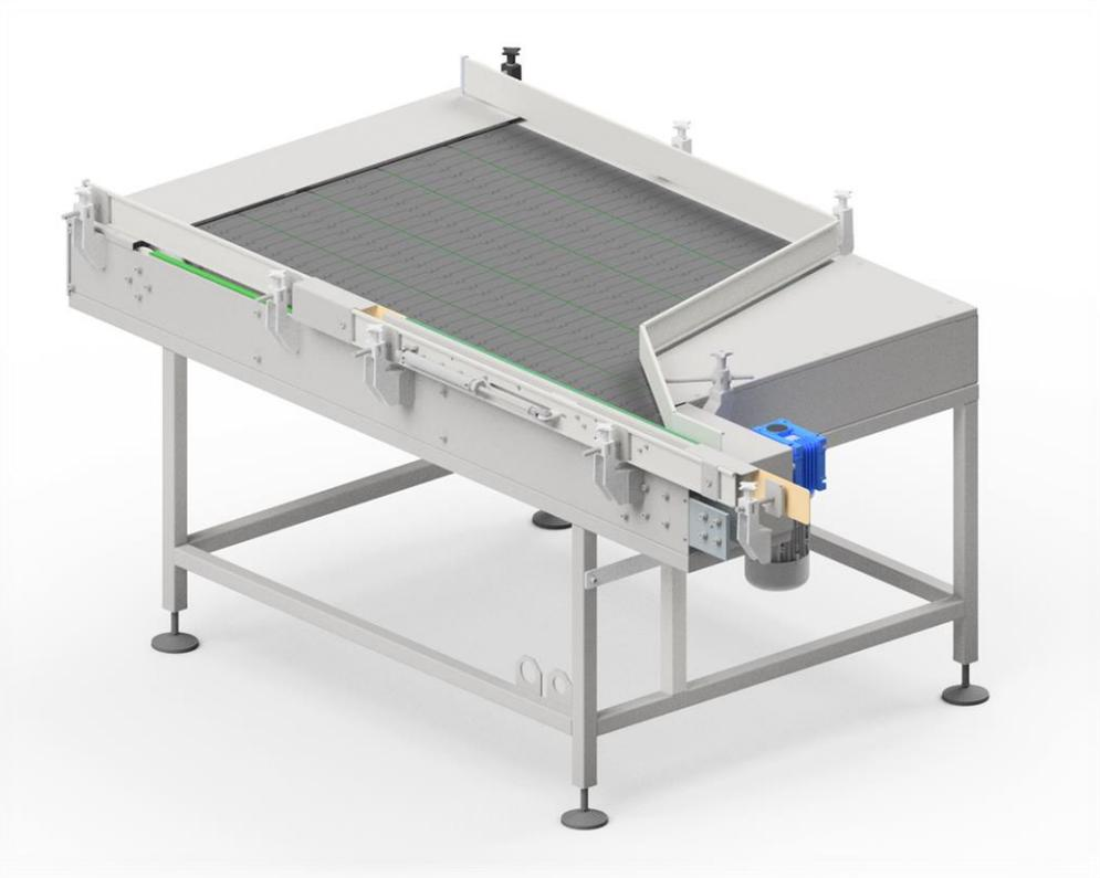
Il tavolo di carico Z-5200 è situato all'inizio della linea di produzione delle bombolette spray. Il principale compito del tavolo di carico è quello di fornire in modo continuo recipienti vuoti, in base ai fabbisogni della linea di produzione. Il tavolo è dotato di una barriera mobile che impedisce il blocco di recipienti all'uscita sul trasportatore a nastro.
