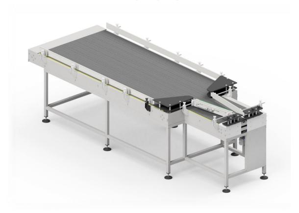
Il tavolo di carico Z-5215 è situato all'inizio della linea di produzione delle bombolette spray. Il principale compito del tavolo di carico è quello di fornire in modo continuo recipienti vuoti, in base ai fabbisogni della linea di produzione. Il tavolo è dotato di una barriera mobile che impedisce il blocco di recipienti all'uscita sul trasportatore a nastro.
