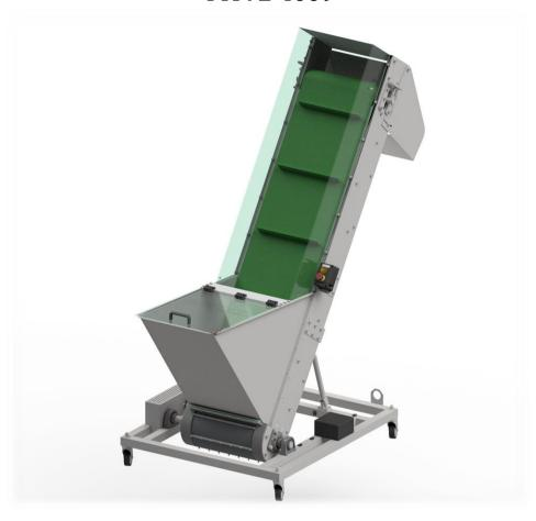
Der Elevator Z-4009 ist eine Maschine zum automatischen Nachfüllen der Elemente im Korb des zugehörigen Sortierers. Der Elevator verfügt über einen Vorratsbehälter mit einem großen Fassungsvermögen, der in langen Zeitzyklen gefüllt werden kann und keine ständige Aufmerksamkeit des Bedieners erfordert. Beide Maschinen arbeiten über ein gemeinsames Sensorsystem im Verbund zusammen.
