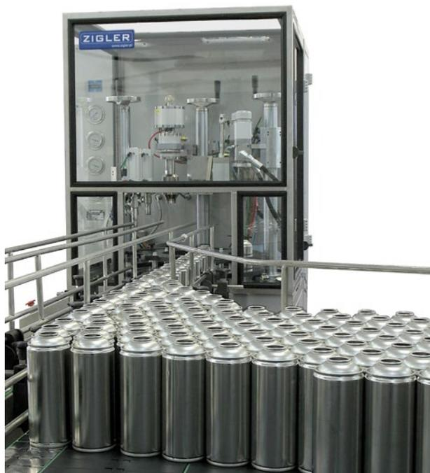
A causa della particolarità di questo prodotto e della produzione stessa della schiuma PU, le macchine per il riempimento di schiuma di poliuretano sono ovviamente diverse dalle apparecchiature per la produzione di aerosol classici. ZIGLER offre tutta la gamma di attrezzature e la strumentazione necessaria per la produzione di poliuretano espanso in aerosol.
