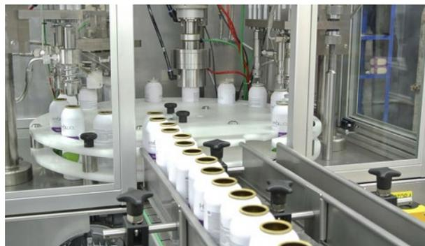
In questa configurazione la linea raggiunge una capacità produttiva fino a 1800 pz / ora e esegue le seguenti operazioni in ciclo automatico:
